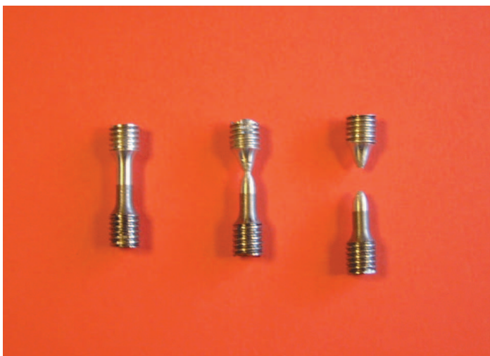
Afbeelding 3 Duidelijk is te zien dat de overgang aluminium/staal in tact blijft bij de trekproef.
