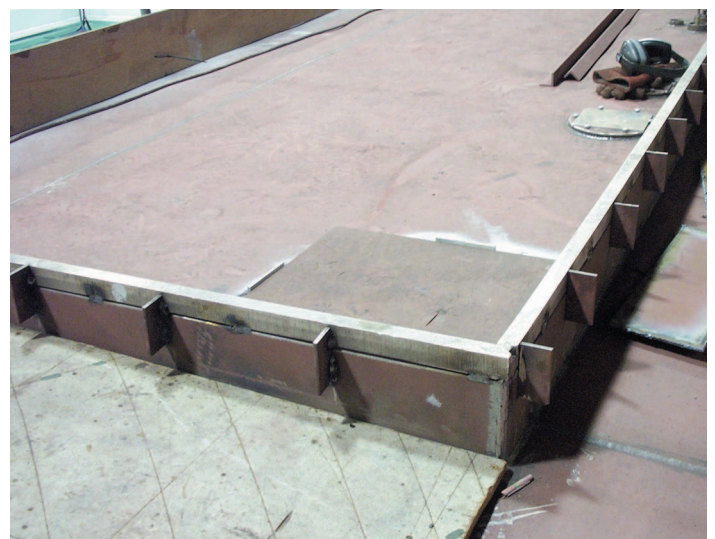
Afbeelding 5 Het dek van het jacht zoals afgebeeld in afbeelding 4 is reeds voorzien van de Triplate verbindingsstroken. (Moonen Shipyard Den Bosch)
