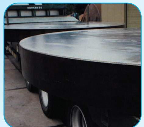
Titanium Claddiscs \phi 3500 \times (260+10)
